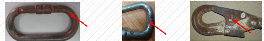
Exemple de elemente metalice defecte
